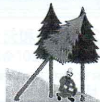
(図3) かかっている立木の伐倒
